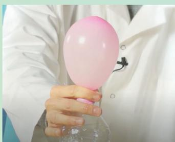
Lorsque l'on mélange du bicarbonate de soude avec du vinaigre, on observe des bulles, comme si ça moussait. Ces bulles ne sont pas vides, elles contiennent du gaz ; du dioxyde de carbone. Dans notre expérience, ce dioxyde de carbone (ou  $\text{CO}_2$ ) s'est échappé de l'éprouvette et est ainsi venu gonfler le ballon.
