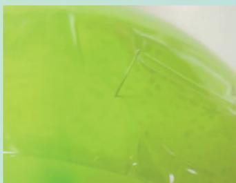
Le scotch permet de créer une "peau" protectrice, plus épaisse que le plastique du ballon. Planter une aiguille à travers permet à l'air de s'échapper tout doucement autour de l'aiguille, mais comme la peau du ballon est devenue plus épaisse, l'espace est plus mince et l'air ne s'échappe qu'en toute petite quantité.
